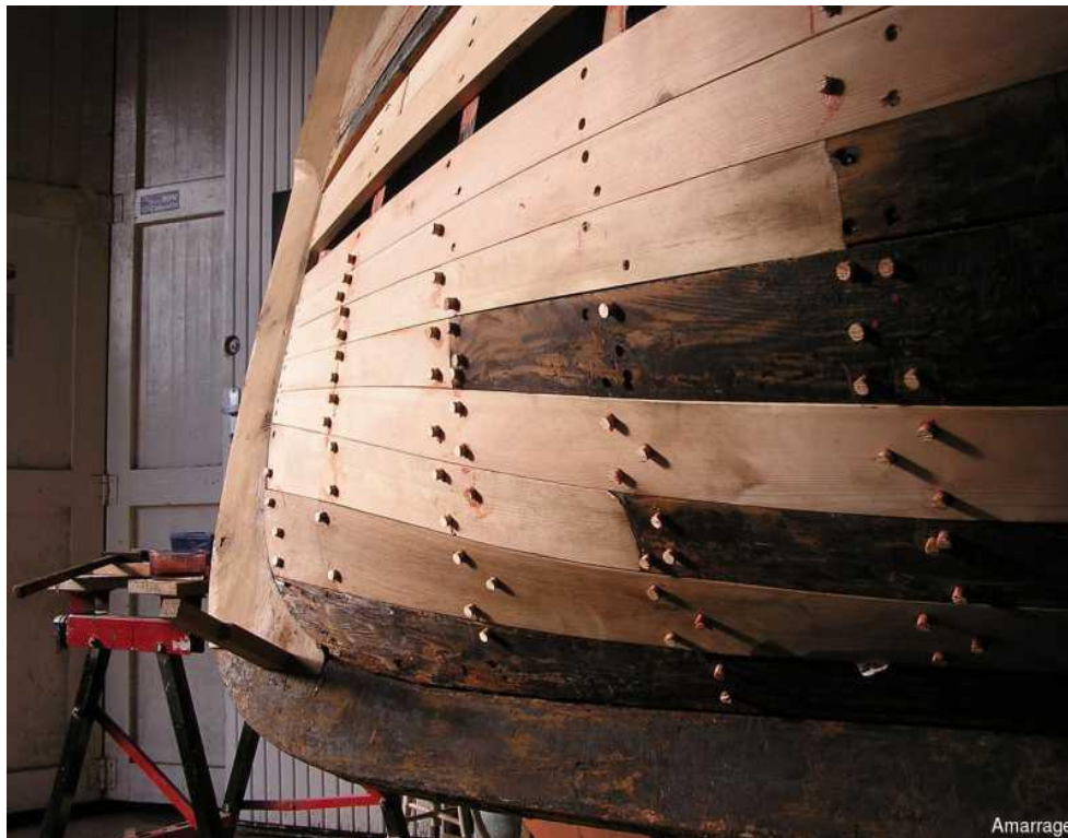
Le Gai-Marin à l'atelier, changement de l'étrave, de bordées... Les Tapons cachent et protègent les têtes de vis.
